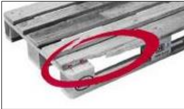
Ein Bodenbrett ist so abgesplittert, dass Nägel sichtbar sind.
