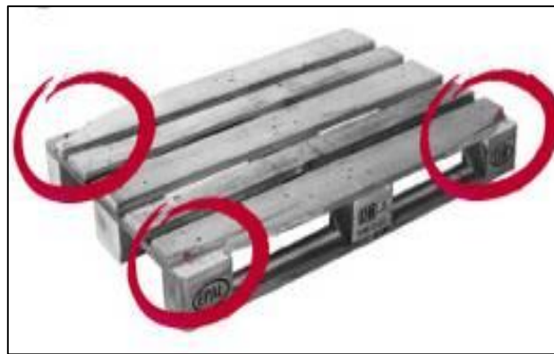
Mehr als zwei Boden- oder Deckrandbretter sind so abgesplittert, dass mehr als ein Nagel sichtbar ist.
