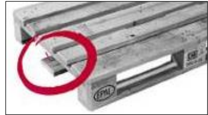
Ein Klotz, oder ganzer Fuß fehlt Fuß ist lose und hängt herunter
